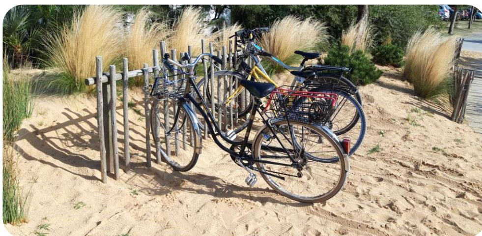
Pour la pose : les poteaux de fixation de 1.80m sont à sceller dans béton (nous vous conseillons de goudronner la partie enterrée du poteau).
